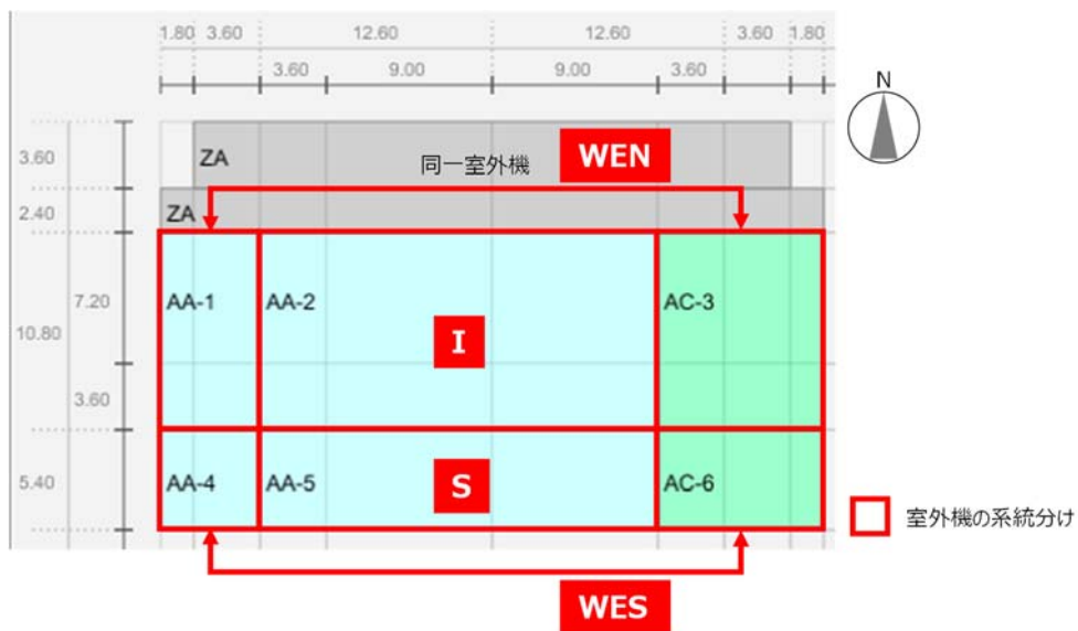
図 1.2.4.69 空調機の系統(④室外機系統混在)
